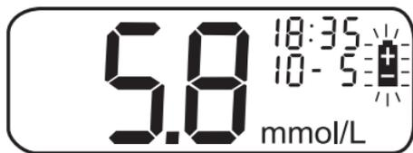
当电池图标在显示屏上自行闪烁时，**您不能进行测量**。您必须安装新电池后才能使用血糖仪。
