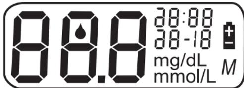
每次打开血糖仪时，启动测量屏幕将持续显示2秒钟。测量屏幕将短暂显示全部显示项，以说明血糖仪工作正常。要检查所有显示项是否在工作，在显示启动测量屏幕时，按住 ▲ 让测量屏幕持续显示。释放 ▲ 继续下一步。
