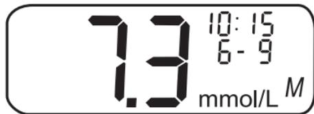
如果您刚完成了一次测量，将试纸留在血糖仪中，按下 ▼ 进入存储模式。最近的血糖测量结果将与“M”一起显示。
