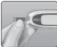
这时血糖仪将打开, 并显示启动测量屏幕, 然后显示代码。第一次使用血糖仪时, 屏幕将显示“[--”, 而不显示代码。
