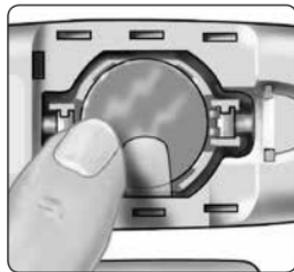
如果在您更换电池后，血糖仪无法开启，请检查电池是否正极(“+”)朝上。如果血糖仪仍无法开启，请致电800-820-1800。
